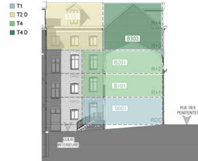
ÉLÉVATION NORD OUEST BÂTIMENT B côté cour Intérieure
